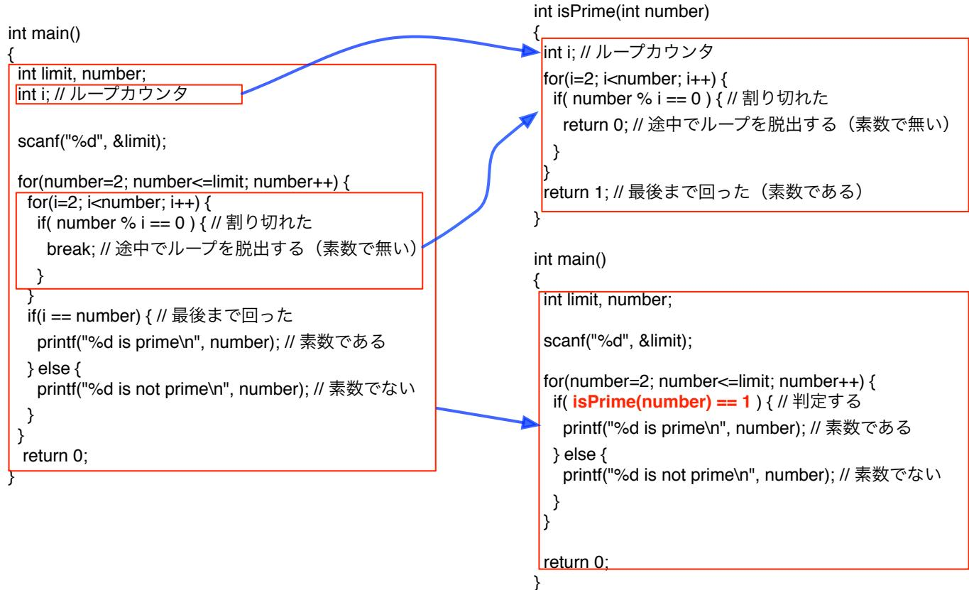
ローカル変数を使うことによって、関数として外に出した処理に「だけ」必要な変数を呼び出し元の main() 処理から見えなくすることができます。つまり呼び出す関数の中でどんな変数がどのように使われているのか、呼び出側は関知しなくて良くなつたわけです。
