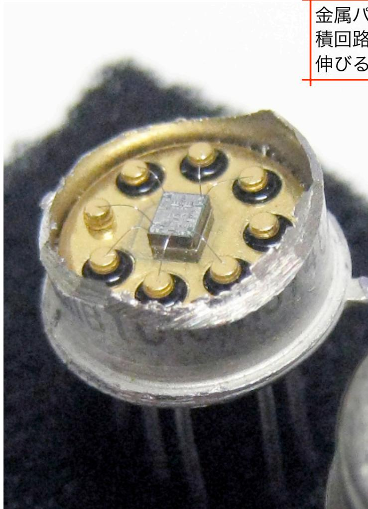
金属パッケージの内部に集積回路が置かれ、電極から伸びる細線で空中配線。
